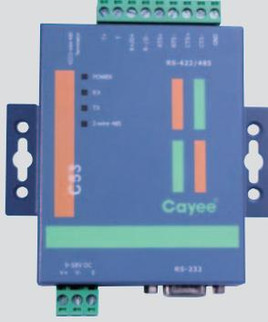
Optoelektronik dönüştürücü bilgisayarın seri portundan gelen RS232 sinyallerini RS485 sinyallerine dönüştürmek için kullanılır. Bu dönüştürücü, sadece RS232 haberleşme modu kullanan bina yönetim sistemlerinde (BMS) kullanılır.
