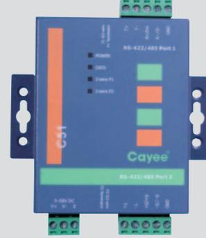
Optoelektronik repeater, haberleşme mesafesi 800 m'yi aşan projelerde sinyal zayıflama tehlikesine karşı koruma için kullanılır. Maksimum 32 devreyi destekler ve haberleşme sinyallerini güçlendirir.
