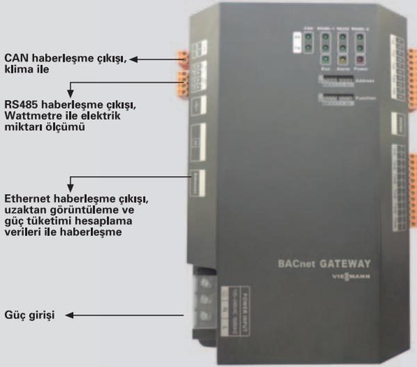
Enerji pay ölçer ekipmanı, güç tüketimi hesap yazılımı, gateway, wattmetre, akım dönüştürücü, yönlendirici, vs... içermektedir. Güç tüketimi hesap yazılımı ve gateway, Viessmann tarafından teslim edilir. ENTES marka Wattmetre, akım dönüştürücü ve yönlendirici lokal olarak temin edilmelidir.
